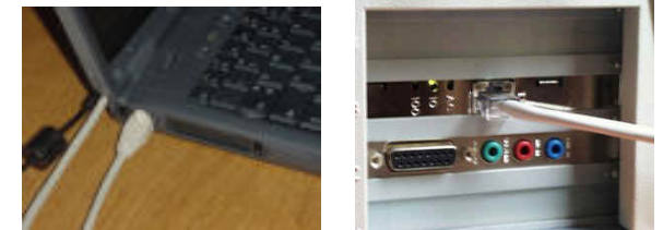
Fig. 1. Où se branche le câble réseau
